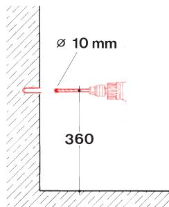
Loch ø 10 mm für Haltebolzen in Wand bohren
