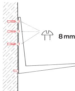
Konsole positionieren und an der Wand befestigen
