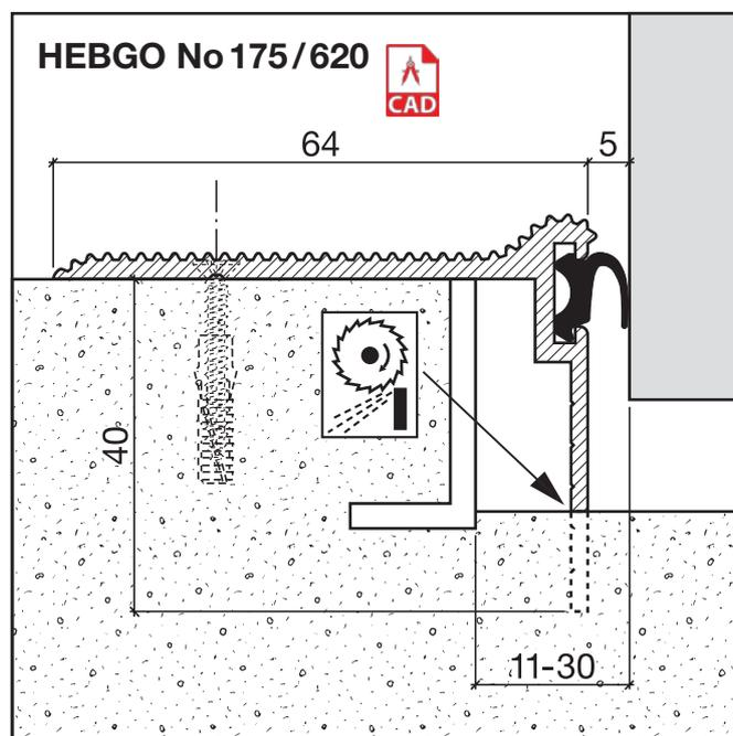
Le profil en aluminium est adapté précisément au seuil, en fraisant la partie verticale de 40 mm à la hauteur souhaitée. Avec le joint en caoutchouc TPE/Silicon, résistant au vieillissement, il forme la nouvelle butée du seuil.
